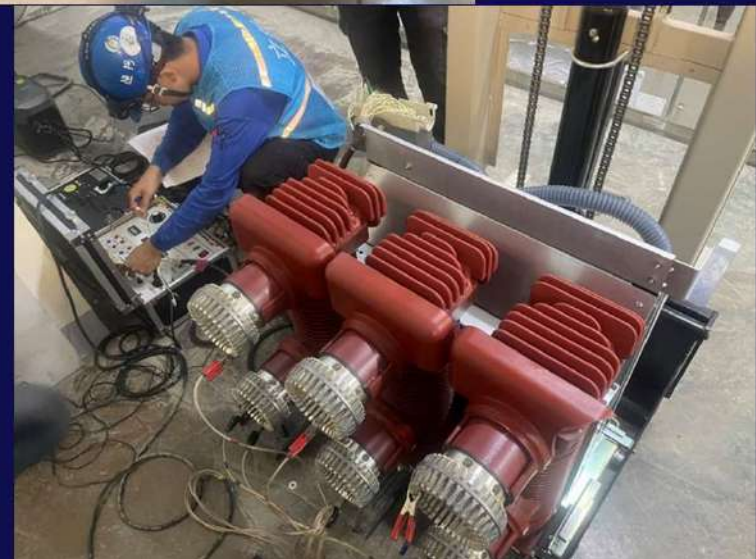
斷路器三相同步試驗
